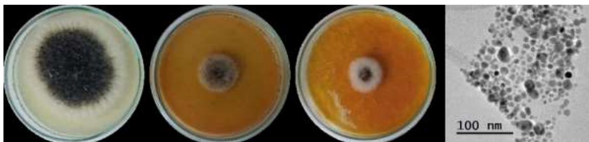
Figura 1. a. Control (PDA inoculado A. brasiliensis ). b. 25ppm (PDA+25ppmAgNPs inoculado A. brasiliensis ). c. 50ppm (PDA+50ppmAgNPs inoculado A. brasiliensis ). d. TEM de Nps de Ag.
